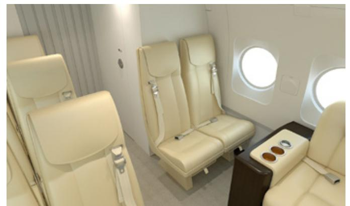
Дополнительное оборудование съемное, что позволяет транспортный интерьер переоборудовать в интерьер повышенной комфортности силами специалистов эксплуатирующей организации в условиях аэродромного базирования вертолета.
